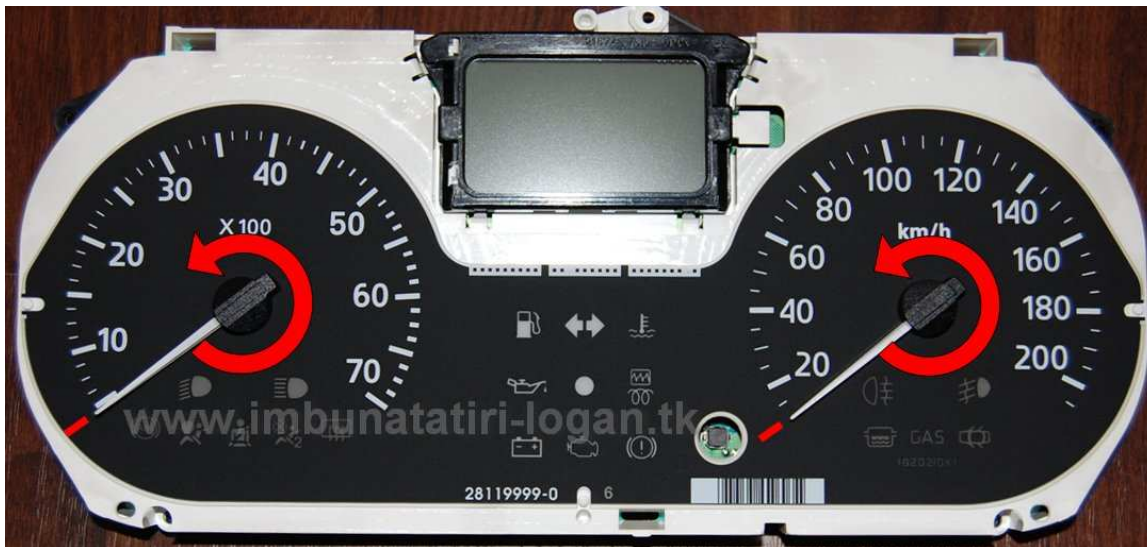
Figura 7 - marcarea pozițiilor de repaus și demontarea acelor indicatoare
